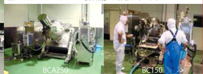
1時間500Kgの揚げかまラインには、脱油ローラー4本を組み合わせた「クアッドロール脱油機」が活躍しています！
