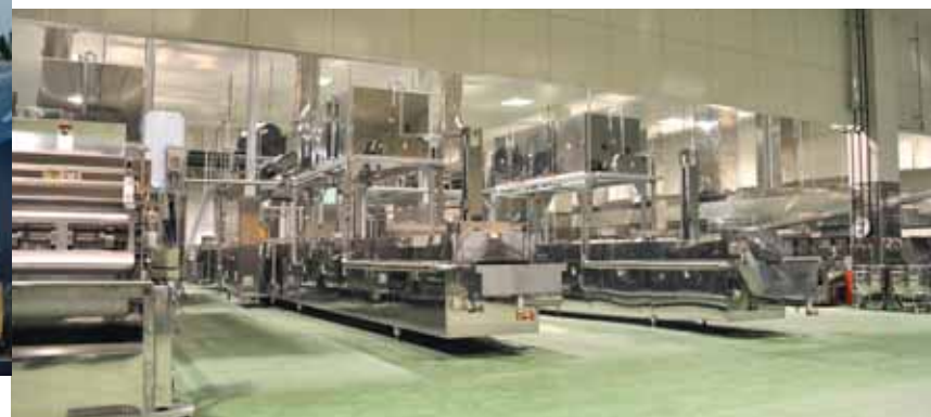
1時間500Kgの揚げかまラインには、脱油ローラー4本を組み合わせた「クアッドロール脱油機」が活躍しています！
