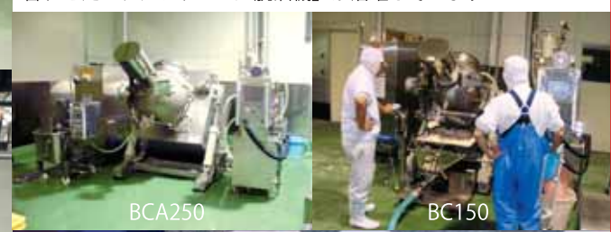
1時間500Kgの揚げかまラインには、脱油ローラー4本を組み合わせた「クアッドロール脱油機」が活躍しています！
